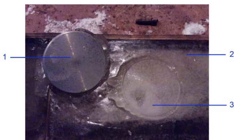
Рисунок 6 – Образец с покрытием (гололед): 1 – мишень, полностью оторвавшаяся от замороженного льда; 2 – монолитный лед; 3 – лед, замороженный на мишень и оторванный в ходе испытания по определению адгезии
