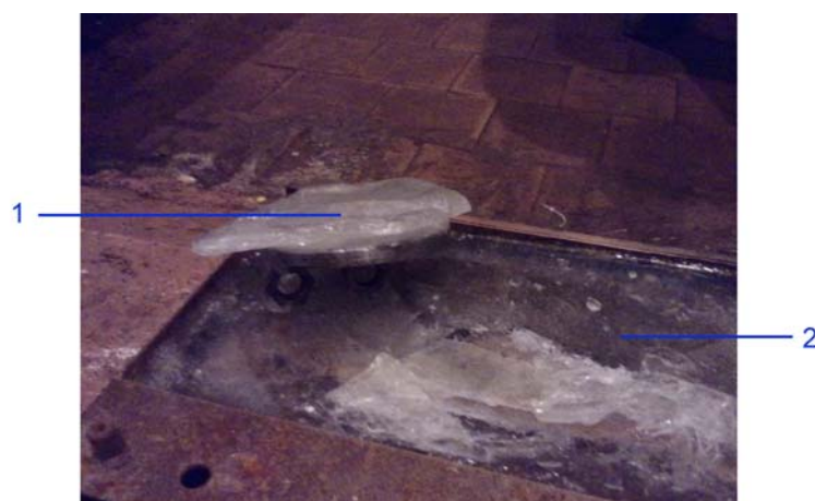
Рисунок 5 – Образец без покрытия (гололед): 1 – мишень с замороженным льдом и куском оторвавшегося монолитного льда; 2 – монолитный лед
