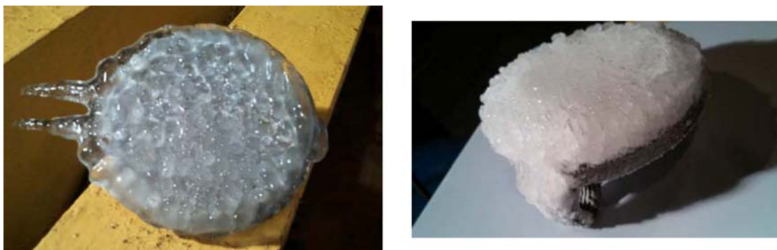
Рисунок 1 – Образец, на котором наморожен гололед (слева) и зернистая изморозь (справа)
